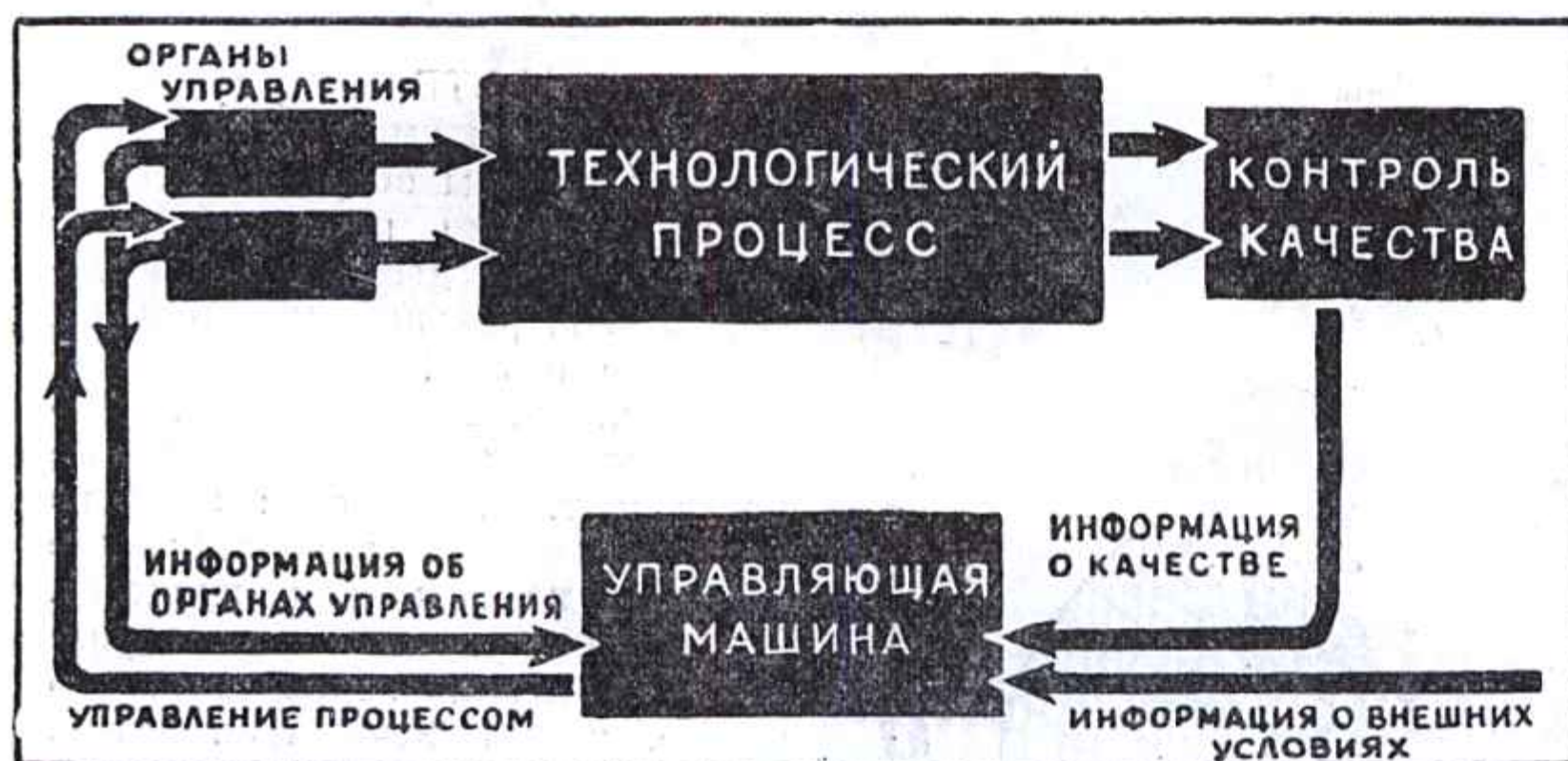
Общая схема управления технологическим процессом при помощи вычислительной машины.
